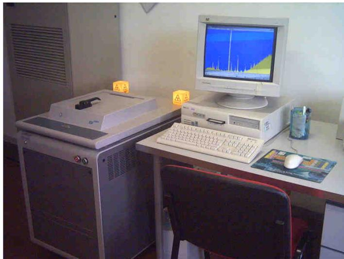
Fig. 9: *Spettrometro ED 2000 prodotto dalla Oxford Instruments*
