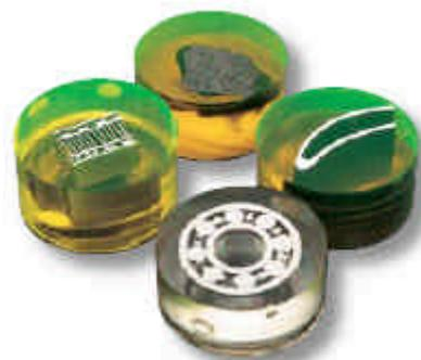
Fig. 4 Inglobamento di campioni in resine epossidiche (immagine presa dal sito [www.struers.it](http://www.struers.it))
