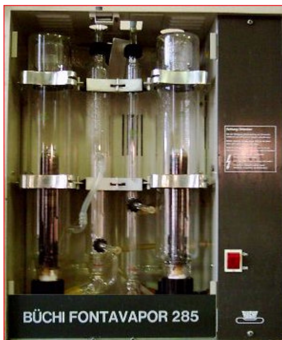
Figura 1. Bidistillatore Buchi Fontavapor 285, modificato in modo da produrre acqua tridistillata
