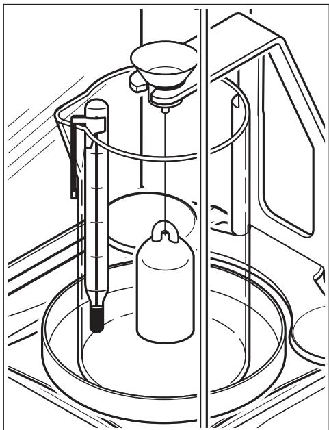
Suspenda el cuerpo de desplazamiento (10) del pescante y asegúrese de que no toca el vaso ni el termómetro.
