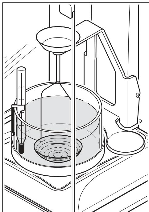
Préparer la balance pour la détermination de la masse volumique (installer la plaque-support, la console, et le plateau creux) comme il est indiqué dans le chapitre 2.
