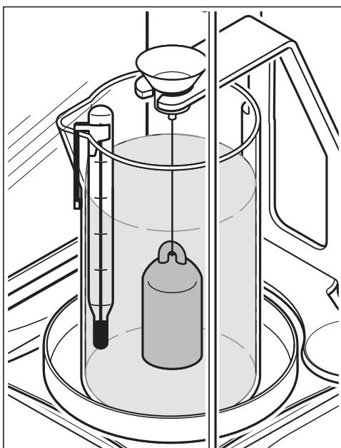
Remplir le becher du liquide dont la masse volumique est à déterminer (jusqu'à env. 1 cm au dessus de l'anneau de fixation du plongeur). S'assurer qu'aucune bulle d'air n'adhère au plongeur (éliminer les éventuelles bulles d'air à l'aide d'un pinceau fin).
