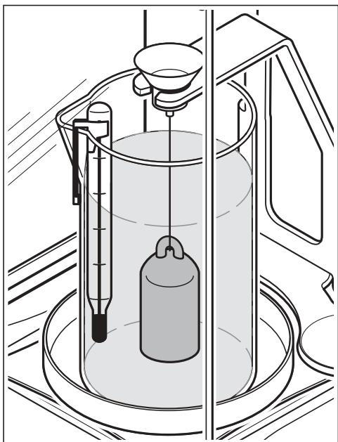
Añada el líquido cuya densidad quiere determinar al vaso (hasta 1 cm por encima del ojete de suspensión del cuerpo de desplazamiento). Asegúrese de que no hay burbujas de aire adheridos al cuerpo de desplazamiento (si las hay, quítelas con un pincel).
