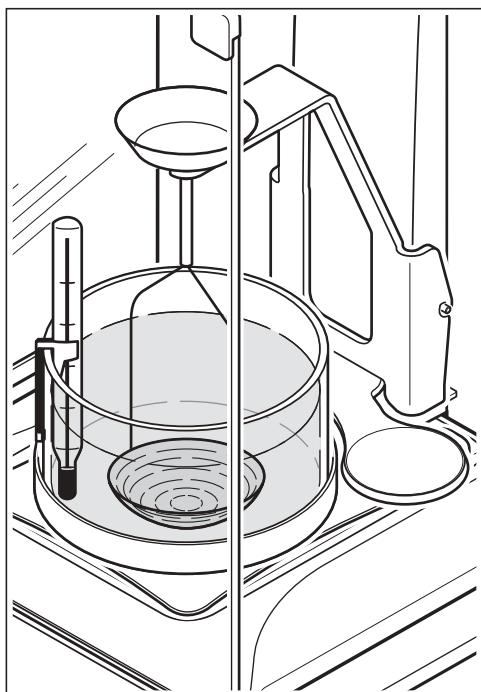
Bereiten Sie die Waage für die Dichtebestimmung vor (Halteplatte, Bügel und Schale installieren) wie in Kapitel 2 beschrieben.
