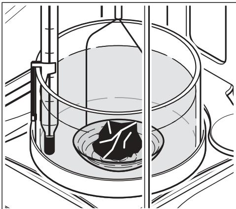
Prendre le solide du plateau, fermer les portes du pare-brise et tarer la balance. Mettre après le solide dans le panier (6). S'assurer qu'aucune bulle d'air n'adhère au solide (éliminer les éventuelles bulles d'air à l'aide d'un pinceau fin).
