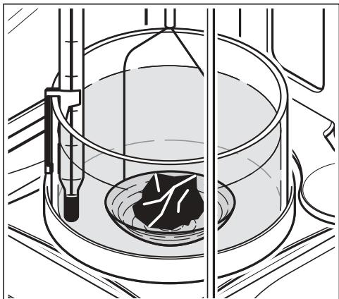
Retire el sólido de la cápsula, cierre las ventanillas del corta-aires y tare la balanza. Coloque después el sólido en la cesta (6). Asegúrese de no hay burbujas de aire adheridas al sólido (si las hay, quítelas con un pincel).
