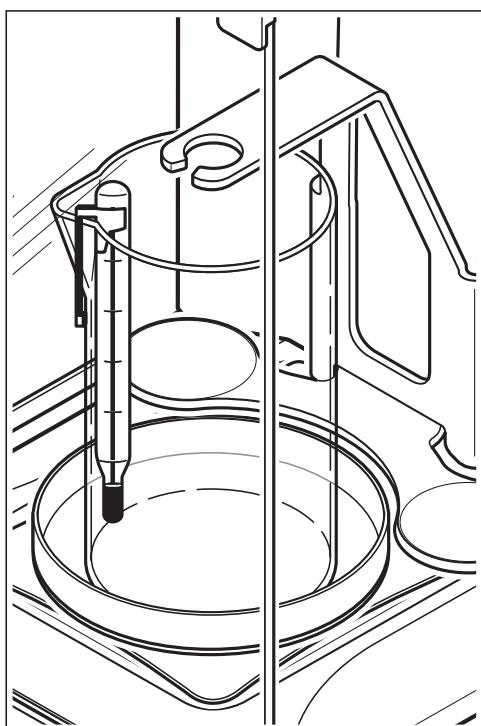
Para determinar la densidad de líquidos utilice el vaso alto (5) y el cuerpo de desplazamiento opcional (10).
