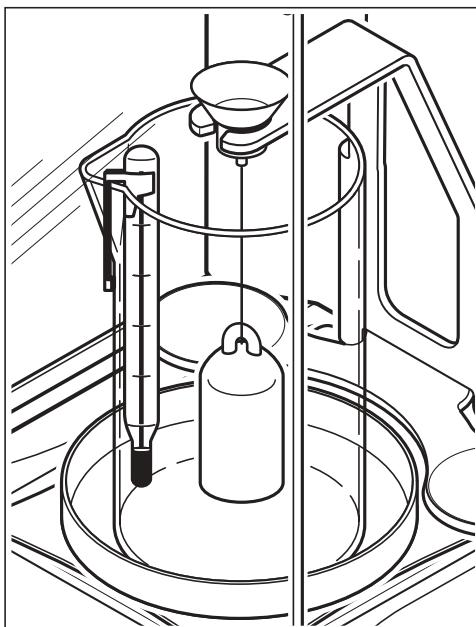
Hängen Sie den Verdrängungskörper (10) an den Bügel und stellen Sie sicher, dass er weder das Glas noch das Thermometer berührt.
