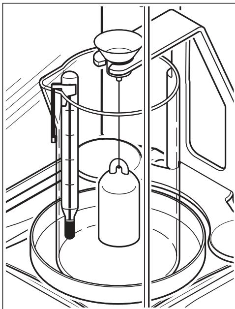
Accrocher le plongeur (10) à la console et s'assurer qu'il ne touche ni le becher, ni le thermomètre.
