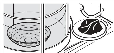
Mettre le solide dans un des deux plateaux du trépied (2). Attendre que l'affichage du poids sur la balance soit stable (le témoin lumineux de stabilité s'allume) et noter le poids affiché A (poids de l'échantillon dans l'air).
