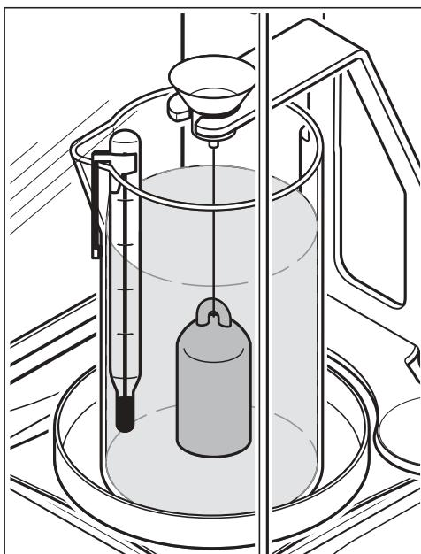
Füllen Sie die Flüssigkeit, deren Dichte Sie ermitteln wollen, ins Glas ein (bis ca. 1 cm über die Aufhängeöse des Verdrängungskörpers). Stellen Sie sicher, dass keine Luftblasen am Verdrängungskörper haften (allfällige Blasen mit feinem Pinsel entfernen).
