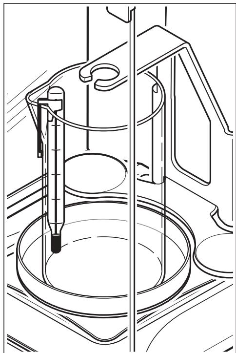
Préparer la balance pour la détermination de la masse volumique (installer la plaque-support, la console, et le plateau creux) comme il est indiqué dans le chapitre 2.
