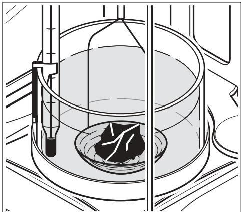
Nehmen Sie den Festkörper aus der Schale, schliessen Sie die Windschutztüren und tarieren Sie die Waage. Legen Sie danach den Festkörper in den Korb (6). Stellen Sie sicher, dass keine Luftblasen am Festkörper haften (allfällige Blasen mit feinem Pinsel entfernen).
