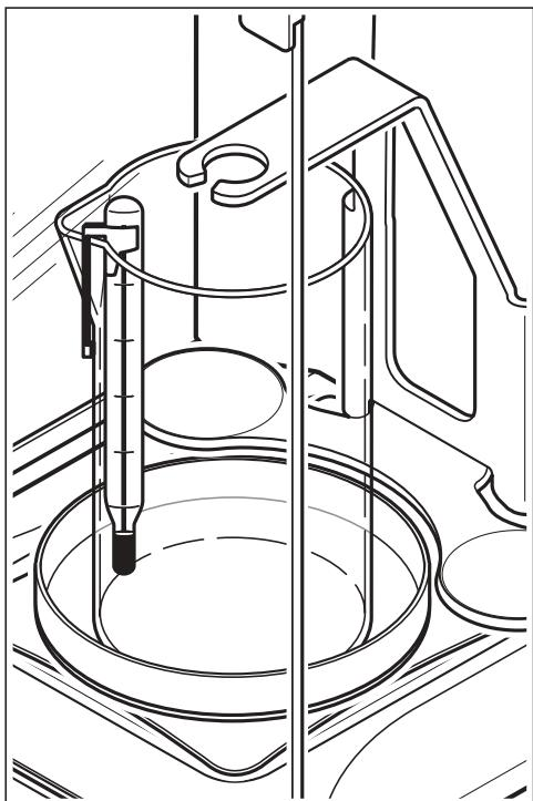
Bereiten Sie die Waage für die Dichtebestimmung vor (Halteplatte, Bügel und Schale installieren) wie in Kapitel 2 beschrieben.
