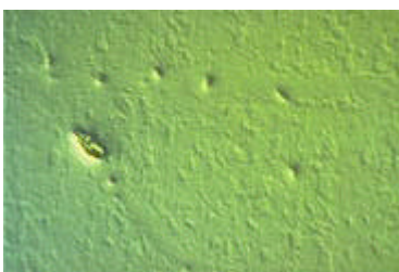
Figura 5 le tracce della lappatura sono chiaramente visibili anche dopo la lucidatura Tantalio puro
